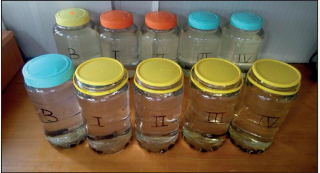
*Ilustración 29. Recipientes estancos para el tratamiento con ácido sulfuroso.*
