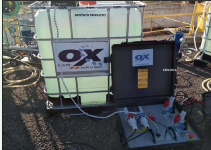
Ilustración 35. Sistema de aplicación del producto.
