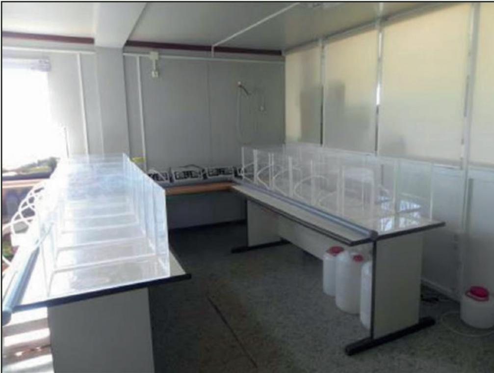
Ilustración 28. Estanques de experimentación donde se ha realizado el tratamiento con peróxido de hidrógeno
