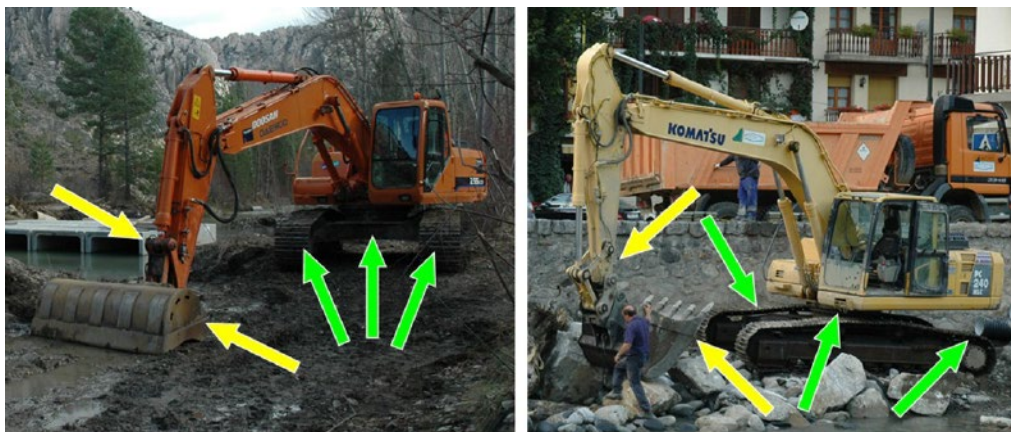
Fotografía 8. Puntos críticos a examinar exhaustivamente en maquinaria de obras: cazos y brazos (flechas amarillas), orugas y bajos de vehículo (flechas verdes).
