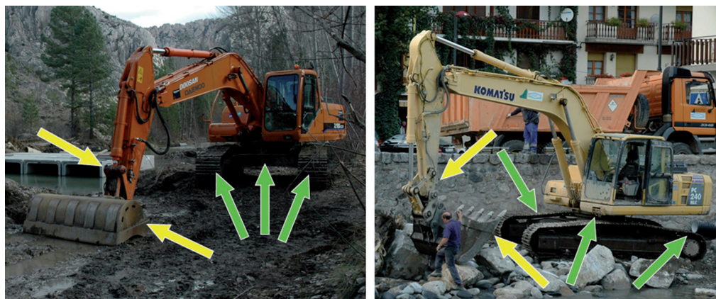
Fotografía 2. Puntos críticos a examinar exhaustivamente en maquinaria de obras: cazos y brazos (flechas amarillas), orugas y bajos de vehículo (flechas verdes).
