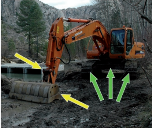
Fotografia 2. Pontos críticos a serem examinados minuciosamente em máquinas de construção: pás e braços (setas amarelas), esteiras e parte inferior do veículo (setas verdes).
