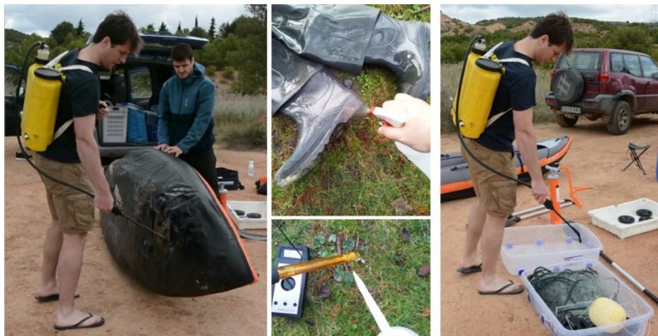
Desinfecção e limpeza do material de amostragem e do sensor de medição.
